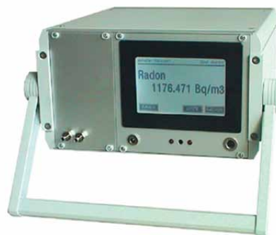
2 pav. Radono tūrinio aktyvumo matavimo monitorius SARAD RTM2200 (autorius nuotrauka)
