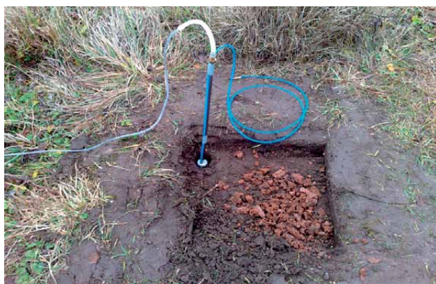
1 pav. Matavimo zondas išgręžtame gręžinyje (autorius nuotrauka)
