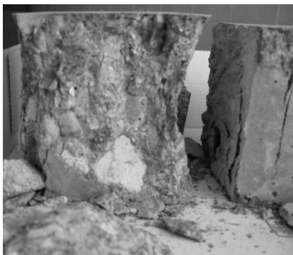
2 pav. Gniuždyti bandiniai, pagaminti iš betono mišinio B-II, po 28 parų kietėjimo
