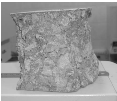
3 pav. Sugniuždytas bandinys, pagamintas iš betono mišinio B-III, po 28 parų kietėjimo
